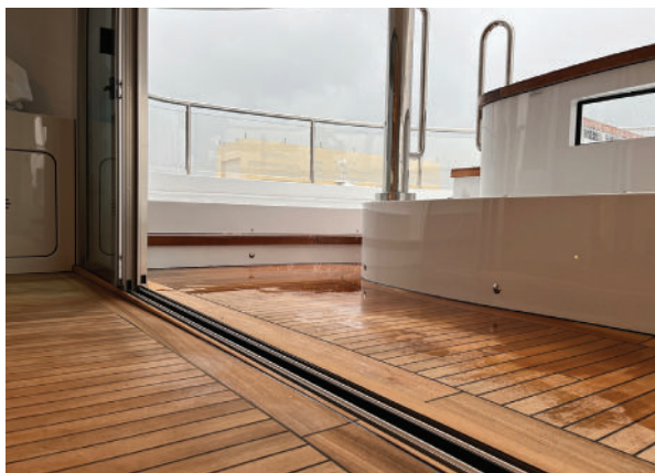
Baie coulissante avec rail intégré et finition du plancher bois affleurant sur la partie centrale.
